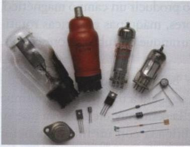
Diodos y transistores y sus ancestros, las válvulas de vacío.
