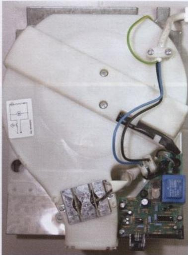
Aparato secamanos automático. Funciona a 230 V (CA) y consta de un receptor (formado por un conjunto turbina-resistencia calefactora), una fuente de alimentación (5 V, CC), un circuito electrónico de control y un sensor (célula fotoeléctrica).
