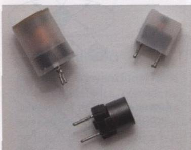
Bobinas de choque para circuitos impresos.
