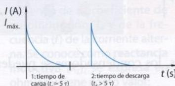
Proceso de carga y descarga de un condensador.
