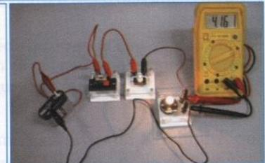
El amperímetro es el instrumento de medida empleado para medir la intensidad de la corriente. Sus terminales se intercalan en el conductor, de forma que por el instrumento de medida circula la corriente que se desea medir (conexión en serie). Este aparato tiene una resistencia interna muy pequeña.
