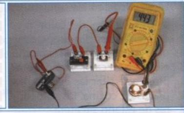
Para medir la potencia, se utiliza un instrumento de medida llamado vatímetro. Está dotado de cuatro terminales: dos para la bobina amperimétrica (que deberá conectarse en serie) y otros dos para la bobina voltimétrica (que deberá conectarse en paralelo o derivación).
