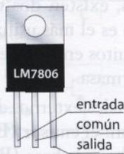
Identificación de los terminales de un regulador de tensión LM7806.
