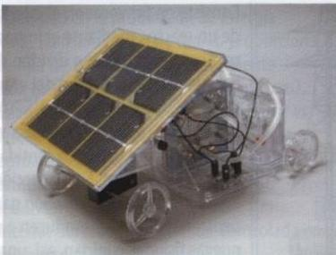
Continuamente se buscan formas alternativas de aprovechamiento energético. El vehículo experimental de la imagen funciona con una célula energética de hidrógeno y un panel fotovoltaico.
